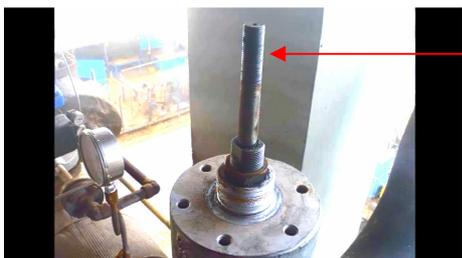
\* a válvula a ser testada deve apresentar a ponta da haste saliente com relação ao parafuso de compressão , afim de conectar o equipamento nela ( normalmente rosca ou furo ) .
