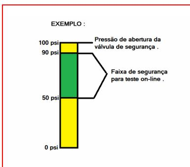
\* a pressão de operação deve estar entre 50% e 90% da pressão de ajuste da válvula .
